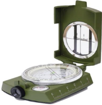
البوصلة الجيولوجية المستخدمة في تحديد وضعية الطبقات الصخرية.
