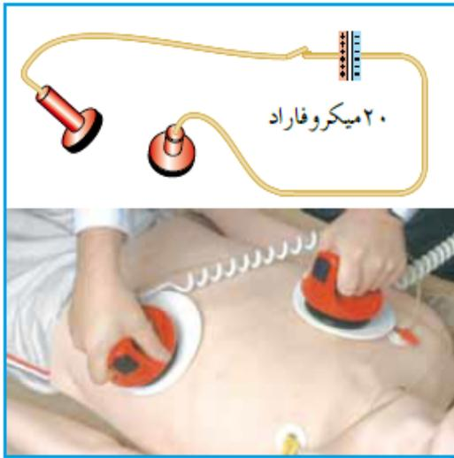
٢ في جهاز إنعاش القلب يعطى المريض شحنة «صدمة كهربائية» عن طريق السماح لمواسع كهربائي بتفريغ شحنته عبر منطقة قلب المريض كما هو مبين في الشكل. إذا كانت مواسعة المواسع (٢٠) ميكروفاراد، وشحن باستخدام مصدر فرق جهده (٦٠٠٠) فولت. فأجب عما يأتي:
