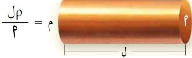
٤ ثلاثة موصلات نحاسية تختلف عن بعضها بمساحة المقطع (P) والطول (L) كما يوضح الشكل (٤-٧)، رتب الموصلات تنازلياً وفق التيار المار في كل منها، عند وصل طرفي كل منها بمصدر فرق جهد (ج).
