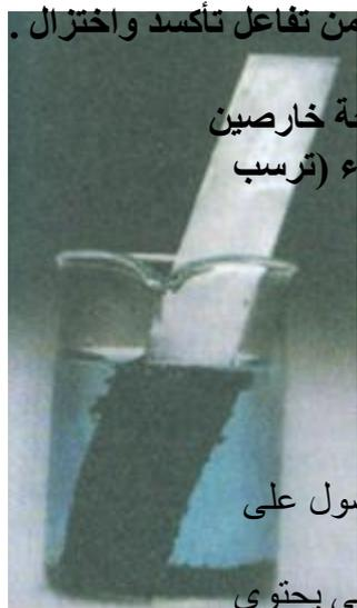
**التفاعل في وعاء واحد** ( كما في الشكل المجاور ) حيث يلاحظ عند غمس صفيحة خارصين Zn في وعاء يحتوي على محلول كبريتات النحاس CuSO<sub>4</sub> تكون طبقة سوداء (ترسب ذرات نحاس نتيجة اختزال Cu<sup>2+</sup> ) على صفيحة Zn ، ( تفاعل تلقائي ) :
