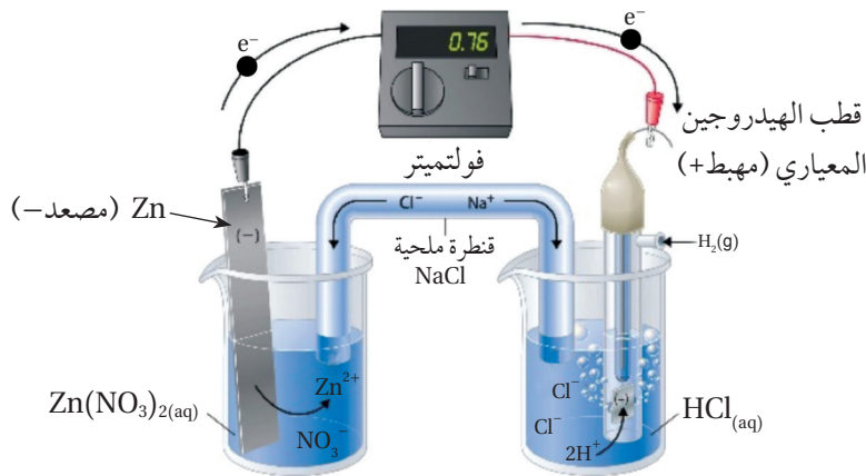
الشكل (7): خلية جلفانية قطباها الخارصين والهيدروجين المعياريان.
