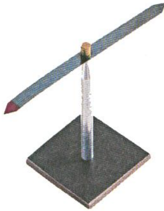
الشكل (٤-٢٠): بوصلة تُستخدم في تحديد الميل المغناطيسي.
