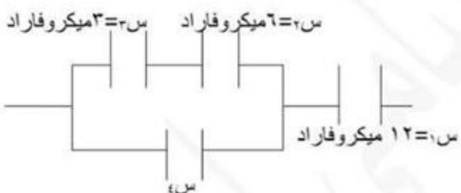
في الشكل المجاور ، اذا علمت ان جهد المواسع (س) يساوي ٤ فولت و الطاقة المخزنة فيه تساوي ٢٤ ميكروجول
