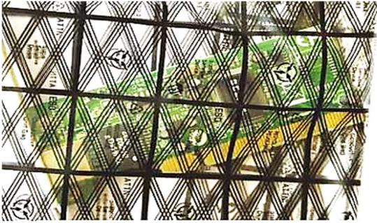
أكياس مصنوعة من مادة موصل لحماية الأجهزة الإلكترونية.
