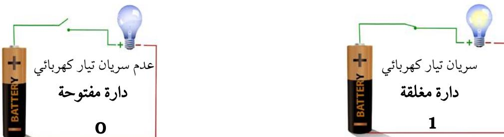
التعبير عن الدارات الكهربائية باستخدام النظام الثنائي
