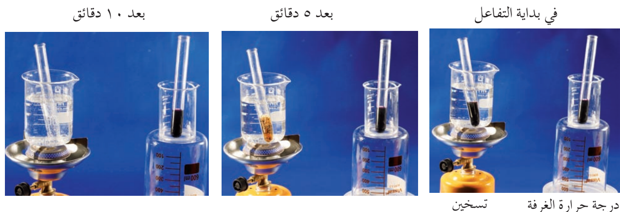
الشكل (٣-١٠) زيادة سرعة التفاعل الكيميائي بزيادة درجة الحرارة.
