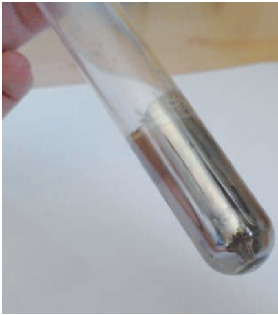
الشكل (٦-٤): تكون مرآة فضية عند تفاعل الألددهايد مع محلول تولينز.
