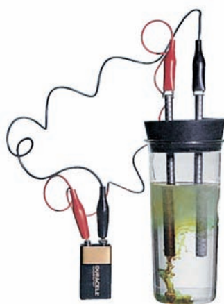
شكل (٢-١٣): خلية تحليل محلول يوديد البوتاسيوم.
