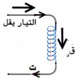
( ب ) القوة الدافعة الكهربائية الحثية الذاتية الطردية : بسبب النقص في التيار المار في المحث تتولد القوة الدافعة الحثية الذاتية بنفس اتجاه محصلة القوة الدافعة للمصدر لتقاوم النقص في التدفق حسب لنز
