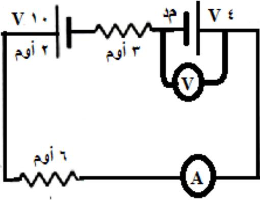
(١) بين الشكل دارة كهربائية بسيطة . معتمداً على الشكل وبياناته واذا علمت ان قراءة الفولتميتر (٤,٥) فولت ما مقدار المقاومة وطريقة توصيلها مع المقاومة (٦)  $\Omega$  حتى تصبح قراءة الامبير (٠,٦) أعبّر ؟
