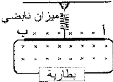
لحل السؤال يجب الانتباه للمعطيات وقراءة السؤال بشكل جيد فالميزان النابضي جهاز يستخدم لقياس القوة (وزن الدارة)، وعندما تصبح قراءته تساوي صفر فهذا يعني انعدام القوة المؤثرة على الدارة الكهربائية المغمورة داخل المجال المغناطيسي.
