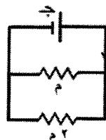
١٨ - في الشكل المجاور إذا علمت أن الطاقة الكهربائية المستهلكة في (م) في فترة زمنية ما تساوي (ط)، فإن الطاقة الكهربائية المستهلكة في (٢م) خلال الفترة نفسها تساوي:
