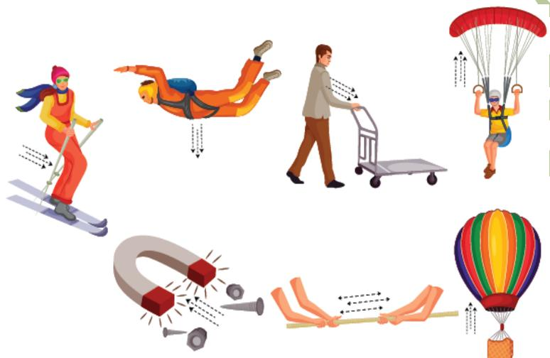
في الشكل المجاور أمثلة على القوى الموجودة من حولنا فلو أخذنا المظلي على سبيل المثال سنجد أنه يتأثر بقوتين: ١. قوة الجاذبية الأرضية (الوزن) نحو الاسفل ٢. قوة احتكاك الهواء (مقاومة الهواء) نحو الأعلى.
