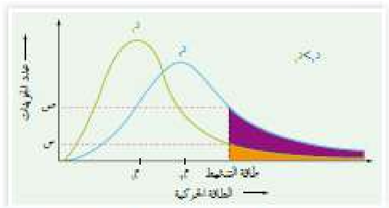
الشكل (3-1) توزيع الطاقة الحركية على جزيئات غاز ما عند درجتى حرارة مختلفتين
