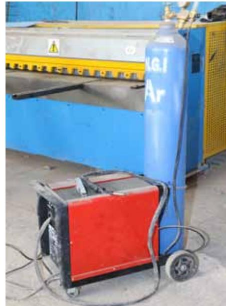
الشكل (٥-٦): آلة اللحام بالقوس الكهربائي المحجوب بالغاز الخامل.
