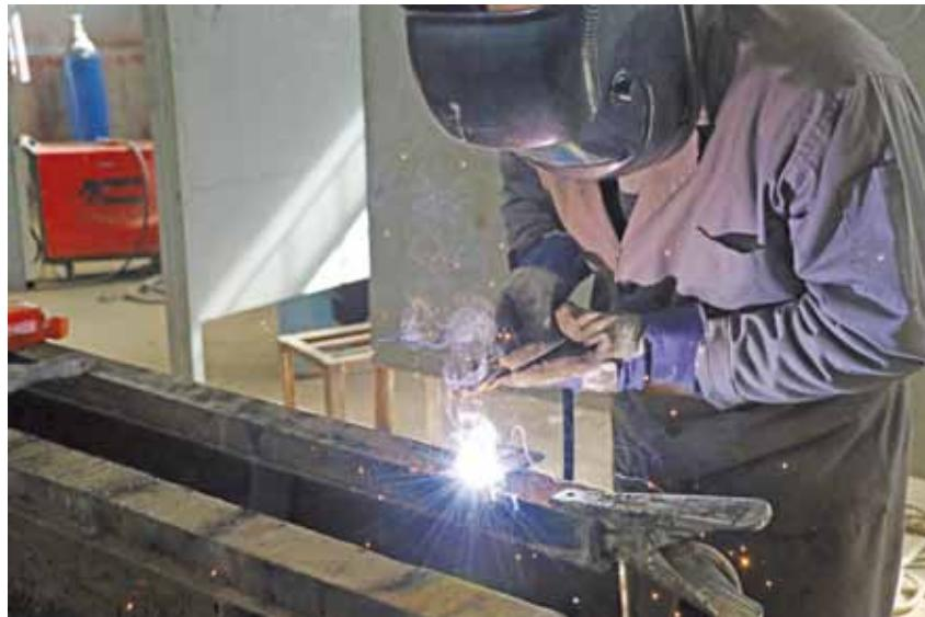
الشكل (٣-٦): اللحام بالقوس الكهربائي.
