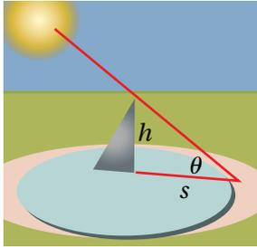
تُعَدُّ المِزْوَلَةُ الشمسية أول ساعة اخترعها الإنسان، وقد استعملها المسلمون لتحديد أوقات الصلاة. يُبَيِّنُ الشكل المجاور مِزْوَلَةَ شمسية ارتفاعها  $h$  وحدة، وتُمَثِّلُ المعادلة:  $s = \frac{h \sin(\frac{\pi}{2} - \theta)}{\sin \theta}$  طول ظلِّ المِزْوَلَةِ عندما يكون قياس زاوية سقوط أشعة الشمس  $\theta$ . هل يُمكن كتابة معادلة طول الظلِّ بصورة أبسط؟
