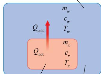
الشكل (8): في تجربة قياس السعة الحرارية النوعية، توضع عينة ساخنة من مادة مجهولة السعة الحرارية النوعية في ماء بارد، في وعاء يعزل النظام عن المحيط الخارجي.
