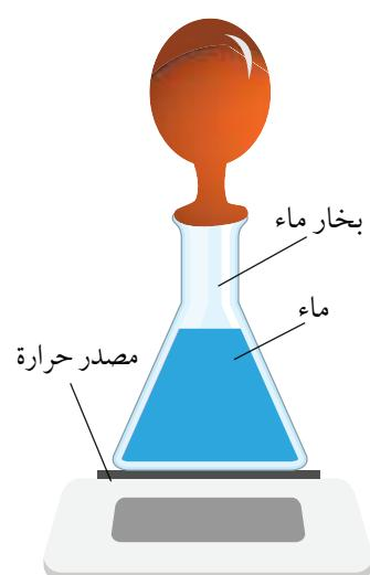
الشكل (17): تحول الطاقة المتنقلة على شكل حرارة الماء إلى بخار، فيبذل البخار شغلاً على الهواء الموجود خارج البالون في أثناء تمدده.
