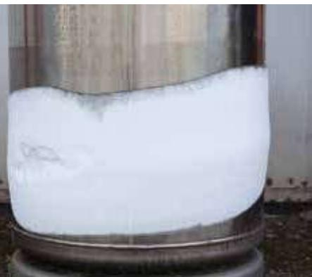
الشكل (16): بذل الغاز المحصور شغلاً على المحيط الخارجي كي يتمدد، فانخفضت درجة حرارة السائل والأسطوانة الفلزية إلى ما دون درجة تجمّد الماء؛ فتجمّد بخار الماء في الهواء الملامس للأسطوانة ليُشكّل طبقة الجليد.
