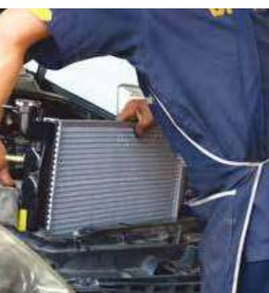
الشكل (5): يُستخدم الراديتير في أنظمة التبريد؛ للتخلص من الطاقة الناتجة في أجزاء المحرك.
