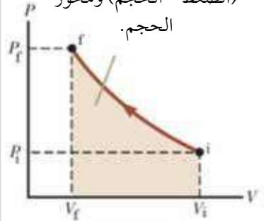
الشكل (23): منحنى (الضغط - الحجم) لعملية ضغط غاز ببطء من الحالة (i) إلى الحالة (f).
