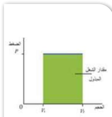
الشكل (19): مقدار شغل المحيط الخارجي (القوة الخارجية)، المبذول على غاز في أثناء تمدده عند ضغط ثابت يساوي عددياً سالب مقدار المساحة المحصورة بين منحنى (الضغط - الحجم) وممحور الحجم.
