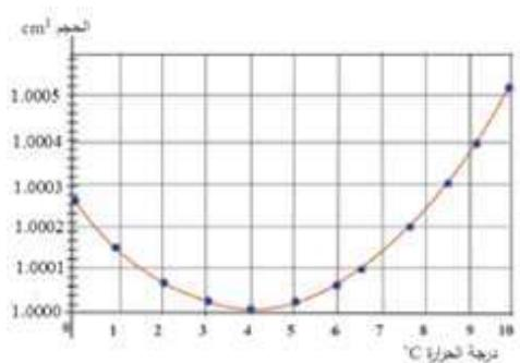
الشكل (39): عند تبريد الماء إلى ما دون ( $4^{\circ}\text{C}$ ) يزداد حجمه.
