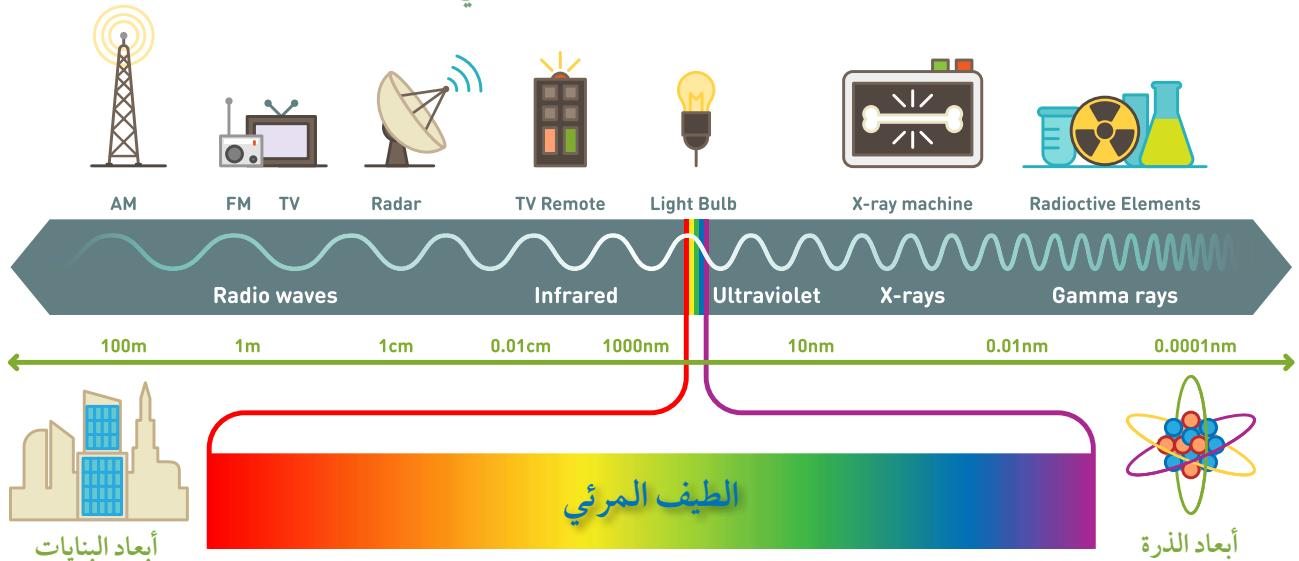
تتراوح الأطوال الموجية للموجات الكهرومغناطيسية من  $10^4$  m (موجات الراديو) إلى  $10^{-12}$  m (أشعة جاما)، وتختلف تبعًا لذلك طاقة كل منها؛ فأشعة جاما أكبرها طاقة، وموجات الراديو أصغرها طاقة. يُبيّن الشكل (3) مكونات الطيف الكهرومغناطيسي المرئي وغير المرئي، وأطوالها الموجية، وبعض استخداماتها!
