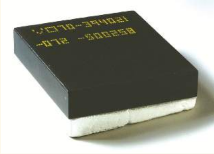
الشكل (٦-١٦): تغليف مقدمة المكوك بالقطع العازلة.
