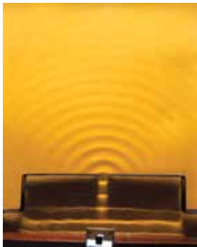
الشكل (22): حيود موجات سطح الماء عند نفاذها من فتحة واسعة وأخرى ضيقة.
