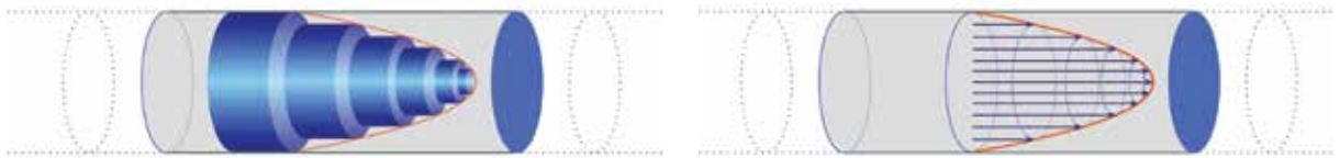
الشكلُ (21): طبقاتُ المائعِ وخطوطُ جريانهِ.
