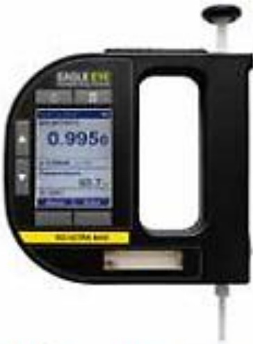
الشكل (14): مقياس كثافة سوائل إلكتروني.
