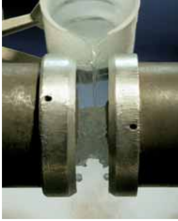
الشكل (٤٤-٥): انجذاب الأكسجين السائل إلى مغناطيس.
