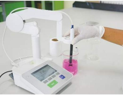
الشكل (10): مقياس الرقم الهيدروجيني.
