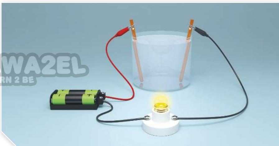
الشكل (2): توصيل محلول HNO<sub>3</sub> للتيار الكهربائي.
