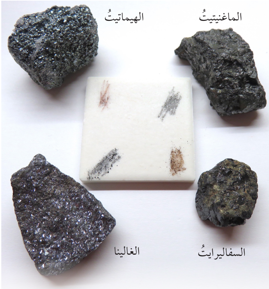
الشكلُ (15): اختلافُ لونِ حِكاكَةِ معدنِ الهيماتيتِ والماغنيتيتِ والسفاليرايِتِ والغالينا.
