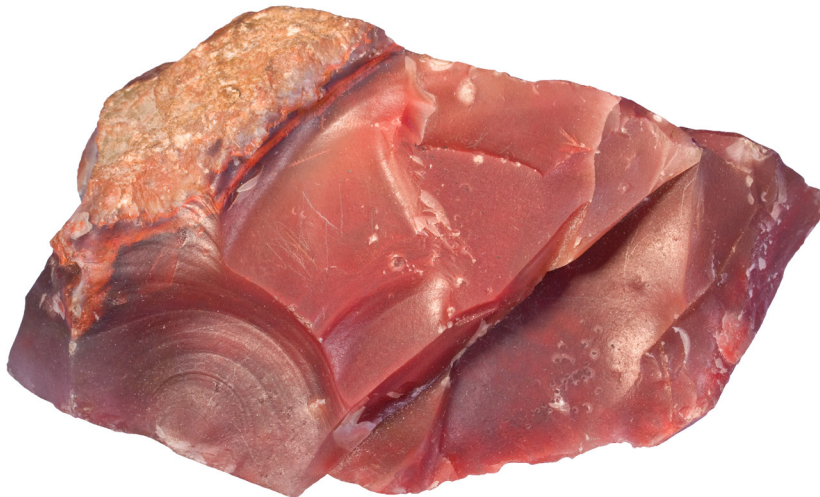
الشكل (18): مكسر محارٍ وغير منتظم الشكل.
