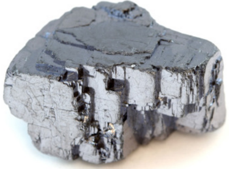
الشكل (16/ أ): يمتاز معدنُ الغالينا بريقه الفلزيُّ.
