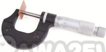
الشكل (3): قياس سُمْك صفيحة باستخدام الميكروميتر.
