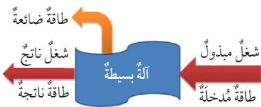
الشكل (13): تحولات الطاقة في الآلة البسيطة.
