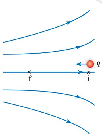
الشكل (7): نقل شحنة اختبار من نقطة إلى أخرى في المجال الكهربائي.
