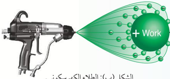
أما عند الطلاء الكهروستاتيكي المُبيّن في الشكل (ب)؛ فإنّ خروج قطرات الطلاء من المصدر يكون بفعل ضغط الهواء، وتخرج القطرات مشحونة بشحنة كهربائية مشابهة لشحنة المصدر، فتتنافر القطرات معه مبتعدة. وبما أن الجسم المراد طلاؤه يُشحن بشحنة كهربائية مخالفة لشحنة مصدر الطلاء؛ فإنّ قطرات الطلاء تتجاذب مع الجسم وتلتصق به، وبخاصة في الأماكن التي يصعب الوصول إليها من دون التجاذب الكهربائي.
