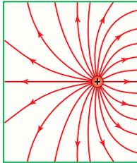
2. **أحلل:** يُمثل الشكل خطوط المجال الكهربائي بين شحنة نقطية و صفيحة مشحونة، أرسم سطوح تساوي الجهد الكهربائي.
