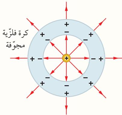
7. **أحلّل الشكل:** وُضعت شحنة نقطية موجبة في مركز كرة فلزية مجوّفة ومتعادلة كهربائيًا؛ فشحنتها بالحثّ كما في الشكل المجاور. أصف ما حدث لتوزيع الشحنات على الكرة، وأصف المجال الكهربائي داخل تجويف الكرة وخارجها.
