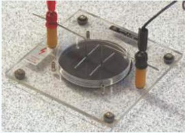
المواد والأدوات: مصدر كهربائي عالي القدرة (0-3 kV) أو مولّد فان دي غراف، طبق بتري زجاجي، قطبان كهربائيان من الألمنيوم، قطع بلاستيكية عازلة لتثبيت القطبين، زيت الخروع أو أيّ زيت نباتي قليل اللزوجة، بذور أعشاب صغيرة الحجم (مثل بذور البقدونس).
