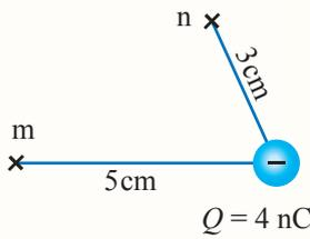
4. **أستعمل المتغيّرات:** شحنة كهربائية سالبة مقدارها (4 nC) موضوعة في الهواء، والنقطة m تبعد عنها (5 cm) والنقطة n تبعد عنها (3 cm) كما في الشكل. أحسب:
