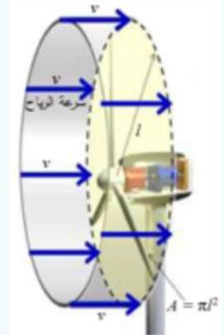
حجم الهواء المار عبر المستوى الذي تُشكّله شفرات التوربين يساوي حجم أسطوانة مساحة مقطعها العرضي ( $A$ )، وطولها في الثانية الواحدة يساوي سرعة الرياح ( $v$ ).
