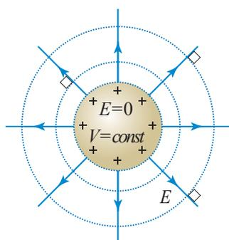
الشكل (22): الجهد الكهربائي لموصل
