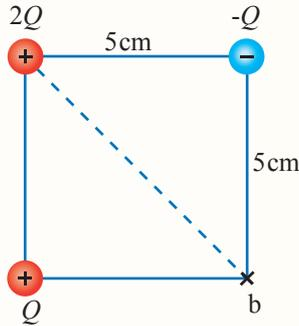
5. **أستعمل المتغيّرات:** (3) شحنات نقطية موضوعة في الهواء، وموزّعة على رؤوس مربع طول ضلعه (5 cm) كما في الشكل. إذا علمت أنّ الجهد الكهربائي عند النقطة b يساوي (400 V)؛ فأحسب:
