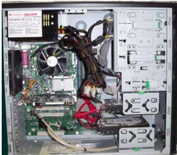
الشكل (١٣-١): المعدات الداخلية لجهاز الحاسوب.
