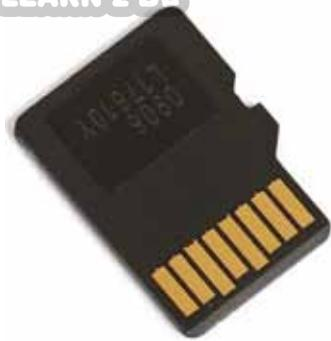
هي بطاقات صغيرة الحجم قابلة للإزالء، وتحتاج عند توصيلها بجهاز الحاسوب إلى قطعة إلكترونية تسمى قارئ البطاقات (Card Reader)، ويستخدم هذا النوع من الذاكرة في الكاميرات الرقمية ومشغلات الصوتيات وأجهزة الهواتف الخلوية، والأجهزة المحمولة الأخرى، كما في الشكل (٢٦-١).
