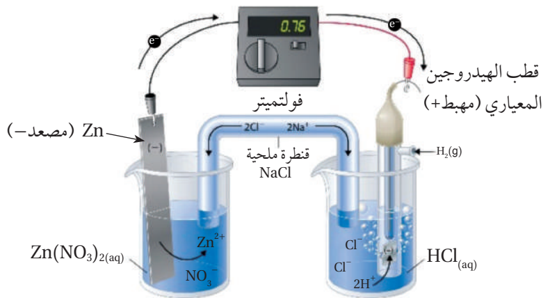
الشكل (7): خلية جلفانية قطباها الخارصين والهيدروجين المعياريان.
