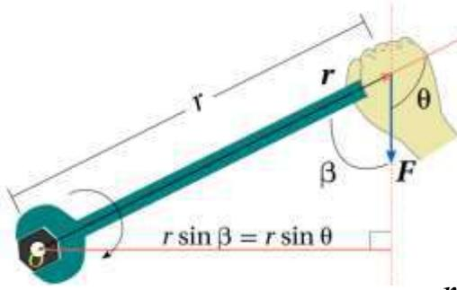
**مثال كتاب :** يستخدم زيد مفتاح شد طوله  $25\text{cm}$  لشد صامولة في دراجة ، حيث أثر بقوة مقدارها  $1.6 \times 10^2 \text{ N}$  في طرف مفتاح الشد في الاتجاه الموضح في الشكل . فإذا علمت أن مقدار الزاوية  $\beta$  يساوي  $75^\circ$  أحسب مقدار العزم المؤثر في المفتاح وأحدد اتجاهه .
