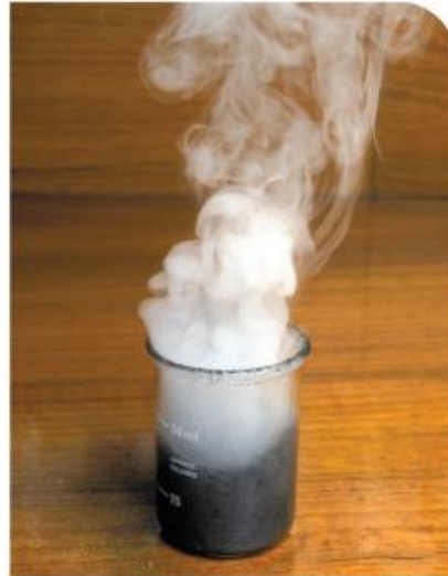
الشكل (7): تفاعل كيميائي بين بيرمنغنات البوتاسيوم وفوق أكسيد الهيدروجين .
