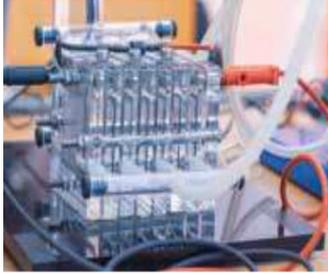
هي خلايا جلفانية تنتج الطاقة الكهربائية من تفاعل غازي الأكسجين والهيدروجين وفق المعادلة الآتية:  $2H_2 + O_2 \rightarrow 2H_2O$
