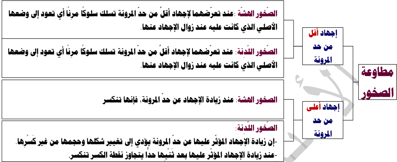
الشكل (2): الإجهاد والمطاوعة في الصخور الهشة واللدنة.
