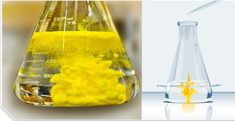
الشكل (9): راسب أصفر اللون يوريد الرصاص (II) PbI_2 .
