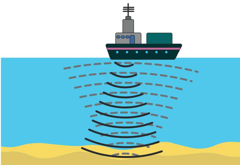
الشكل (5): استخدام العلماء أجهزة السونار لقياس أعماق المحيطات.
