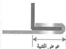
٣- الشكل المجاور يبيّن إحدى طرق ربط مجرى الهواء، وتشير الرسم (١) إلى:
