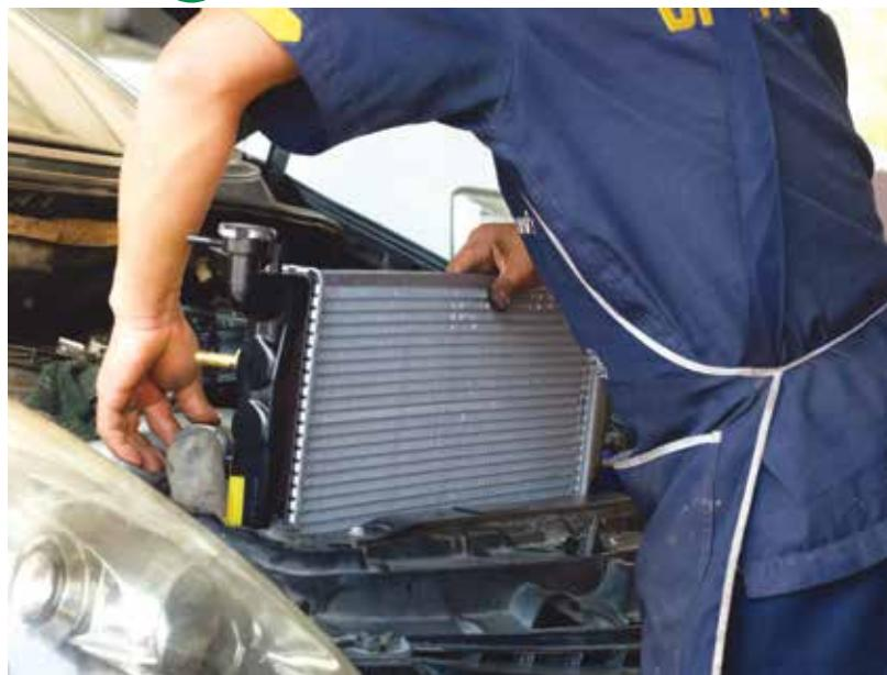
الشكل (4): يستخدم الراديتور في أنظمة التبريد؛ للتخلص من الطاقة الناتجة في أجزاء المحرك.
